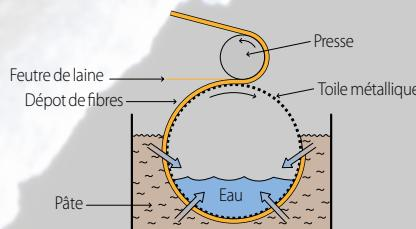
Cette méthode de fabrication offre plusieurs avantages dont le plus important est une meilleure répartition des fibres contrairement à la machine à table plate. Les limites de vitesse de fabrication et de petites laizes imposées par cette machine restreignent son usage aujourd'hui à des fabrications de papiers haut de gamme.
