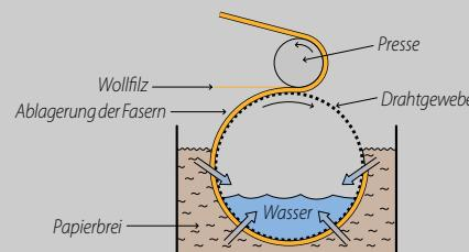
Einer der wichtigsten Vorteile dieses Herstellungsverfahrens im Vergleich zur Langsiebmaschine liegt in der besseren Verteilung der Fasern. Aufgrund der geringen erreichbaren Produktionsgeschwindigkeiten und der kleinen Bahnenbreiten dieser Maschine beschränkt sich ihr Einsatz heute auf die Herstellung hochwertigster Papierprodukte.
